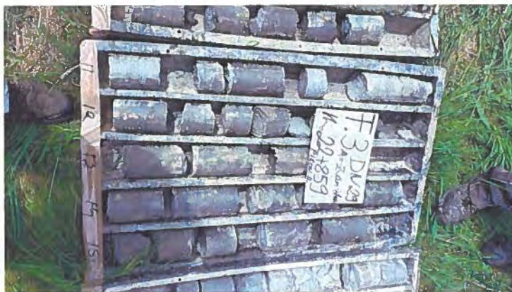
Figura 12.c: Stratificația întâlnită în forajul F3
