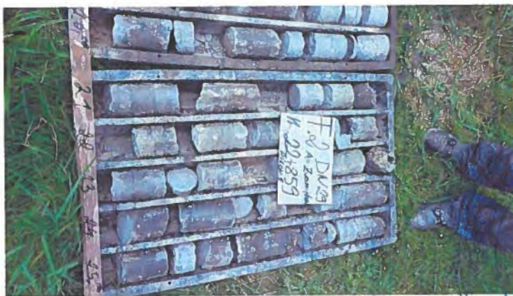
Figura 11.e: Stratificația întâlnită în forajul F2
