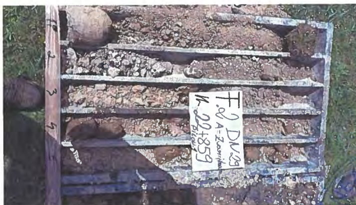
Figura 11.a: Stratificația întâlnită în forajul F2
